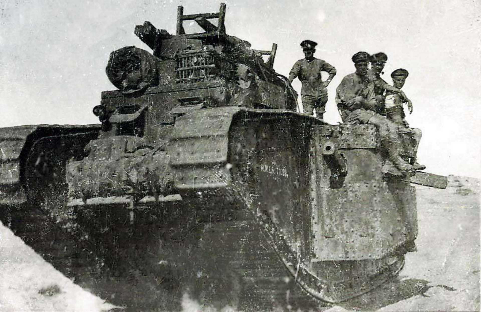
שם טנק ה"נקבה" שבתצלום הוא דווקא גברי מאוד: "טייגר". בתצלום זה נראות שתי מכונות היריה הכבדות שהותקנו מכל צד של הטנקים בתצורת חימוש זאת.
