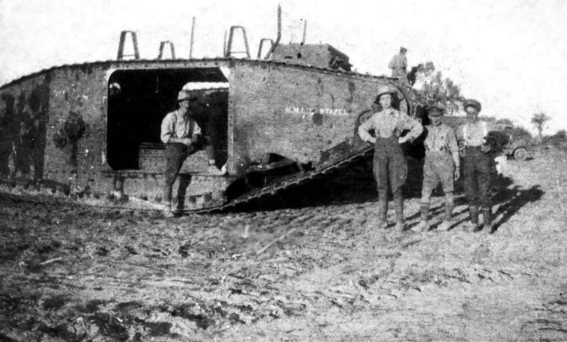
טנק ה"זכר" הרביעי של היחידה כונה בהומור OTAZEL – עגה אנגלית למילים Hot as Hell, כלומר "לוהט כגיהנום". בתצלום נראה הטנק לאחר שצריחוני התותחים פורקו ממנו, כדי לאפשר איורור טוב ולהקל על התנועה והתימרון. מובן שלקראת קרב, הורכבו הצריחונים בחזרה.
